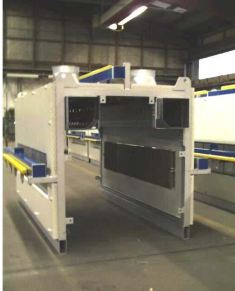
IR-Trocknerelement zur Gelierung von Pulverlack auf Motorblöcken
